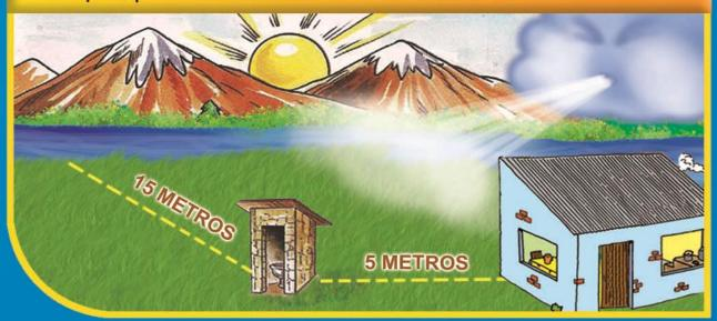
2.- Haz un hueco de 0.80 m de largo  $\times$  0.70 m de ancho y de ser posible 2 metros de profundidad. Si encuentras agua cambia el lugar del hueco.
